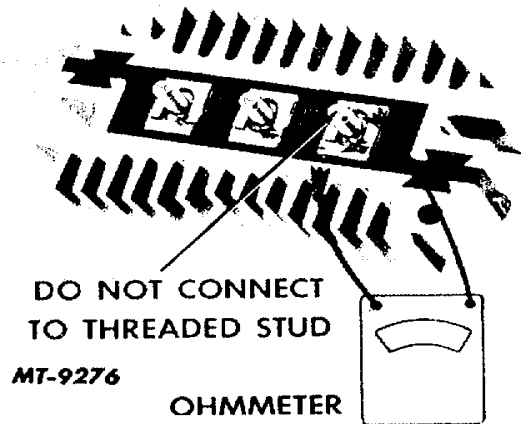
Fig. 9 Rectifier Bridge Check
